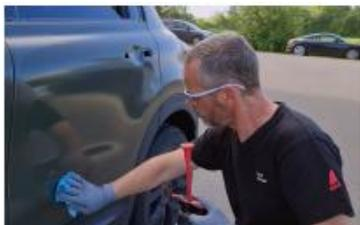
Preparación de la superficie para la medida con el espectro
